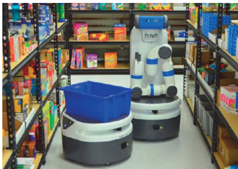
Slika 2. Prikaz robota za dohvaćanje i robota za prijevoz robe kroz skladište [7]
