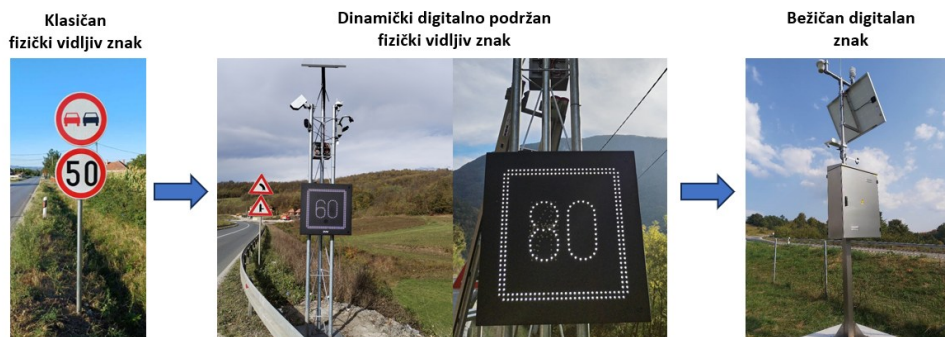
Slika 1: Evolucija saobraćajnog znaka: od fizičkog, preko digitalno podržanog, ka digitalnom znaku
