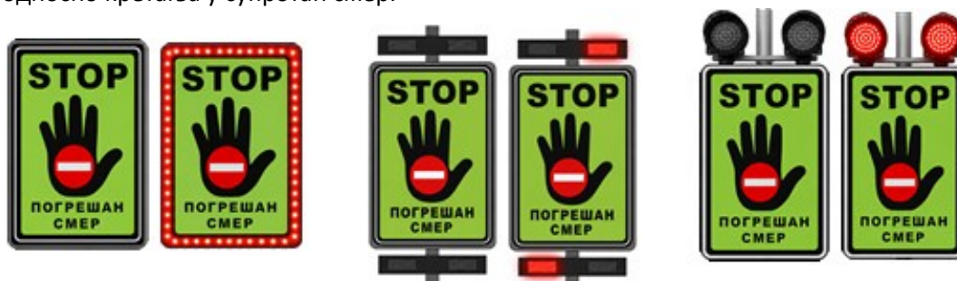
Слика 2. Приказ три могућа начина унапређења саобраћајног знака „Погрешан смер“ (III-86) а) LED трепћући рам знака, б) правоугаони трепћући светлосни сигнали, в) округли црвени трептачи Ф300mm, извор: Аутори рада
