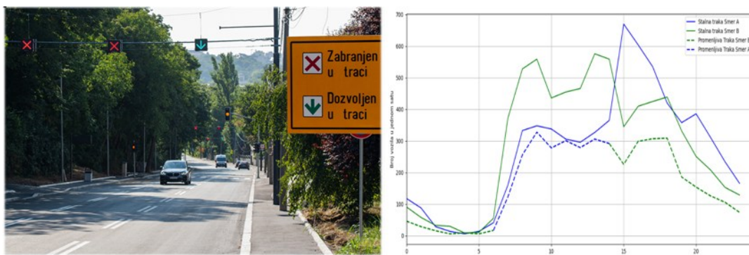
Slika 4: Primer primene alternativne svetlosne signalizacije u Ulici Teodora Drajzera u Beogradu (levo) i časovni protoci po trakama na sredini posmatrane deonice (desno) [3]
