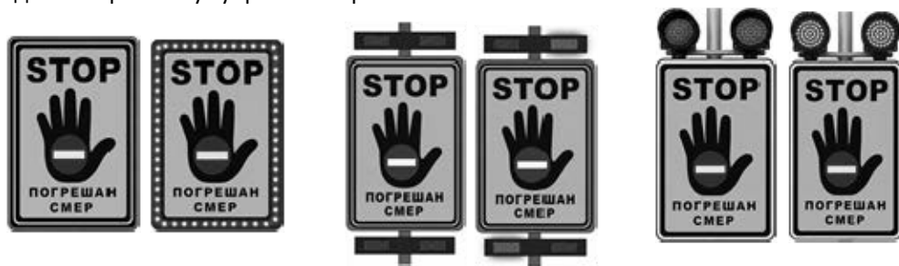
Слика 2. Приказ три могућа начина унапређења саобраћајног знака „Погрешан смер“ (III-86) а) LED трепћући рам знака, б) правоугаони трепћући светлосни сигнали, в) округли црвени трептаци Ф300mm, извор: Аутори рада
