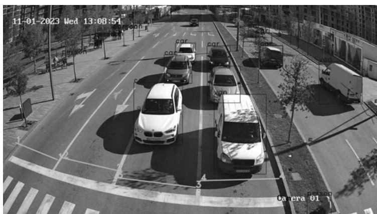
Slika 1. Detekcija sa automatskim određivanjem klase vozila
