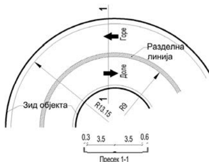
Слика 4. Димензије двосмерне закривљене рампе
