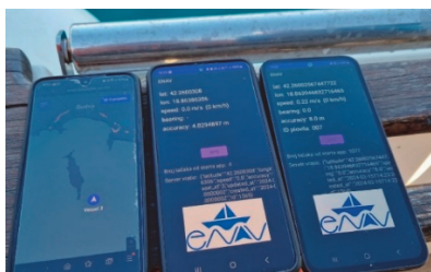
Slika 3. Prikaz poređenja preciznosti GNSS pozicioniranja na različitim uređajima
