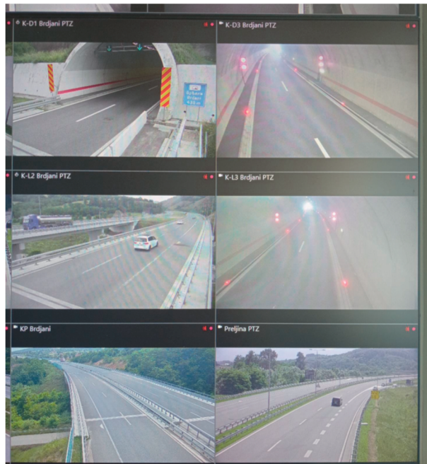
Слика 3. Систем видео надзора тунелских објеката
