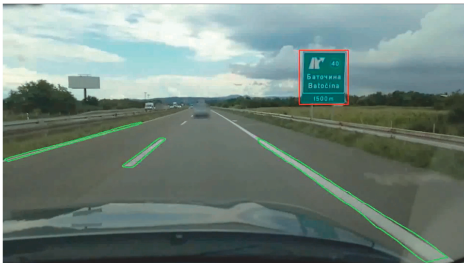
Slika 3. Automatsko prepoznavanje horizontalne i vertikalne signalizacije na putu
