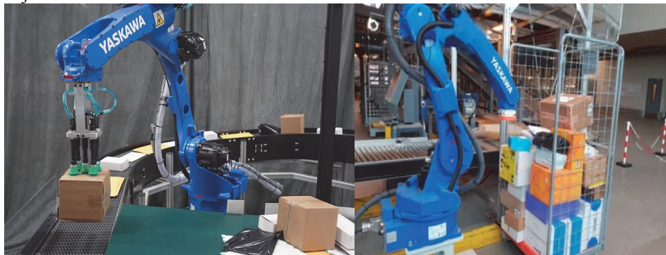
Slika 1. Manipulativni robot Yaskawa GP12 u radu [12]
