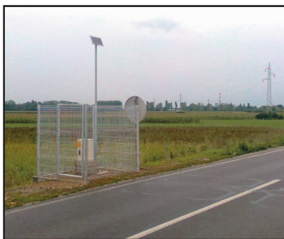
Slika 1. Automatski brojač saobraćaja baziran na induktivnim petljama
