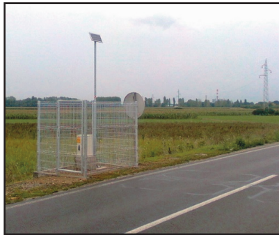
Slika 1. Automatski brojač saobraćaja baziran na induktivnim petljama
